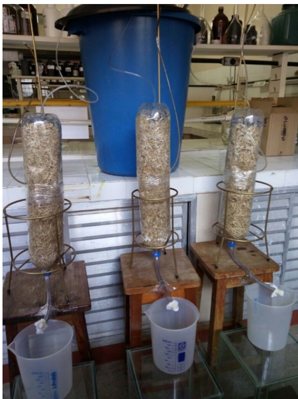
Figura 1. Detalhe da estrutura utilizada no processo de filtração utilizando filtros orgânicos constituídos de palha de feijão no tratamento da ARS.
