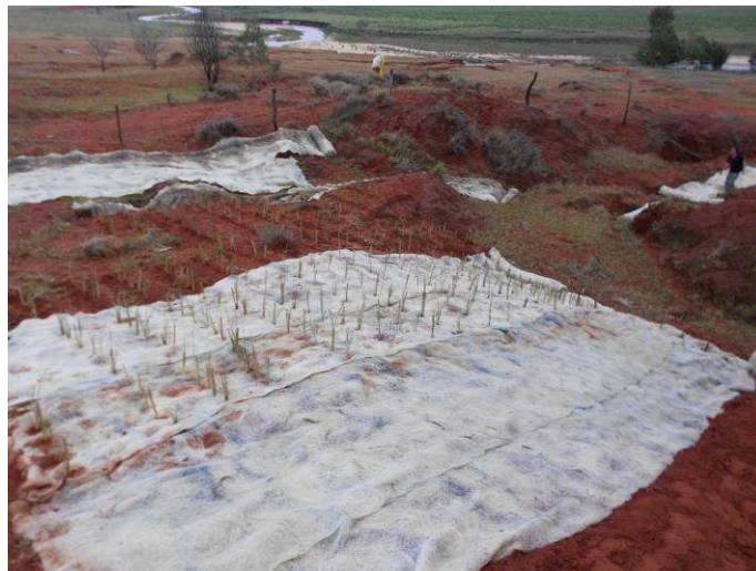
Figura 2: Implantação de unidades de avaliação de capim Vetiver sem manta (canto esquerdo da foto) e Vetiver com manta (centro da foto), em setembro de 2015. Fonte: C.L. Vieira, 09/2015.
