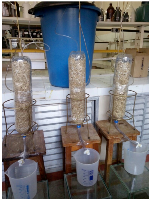
Figura 1. Estrutura utilizada durante a operação dos filtros orgânicos
