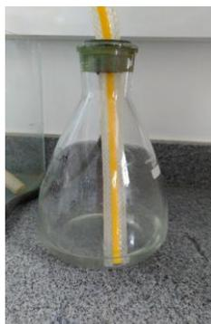
**Figura 4** - Solução de hidróxido de sódio (NaOH, a 5% m/v). Foto: Felipe Mazza (2017).
